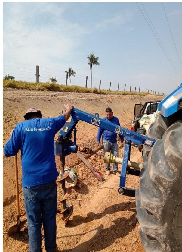
– Sondagem e Coleta de Amostra
