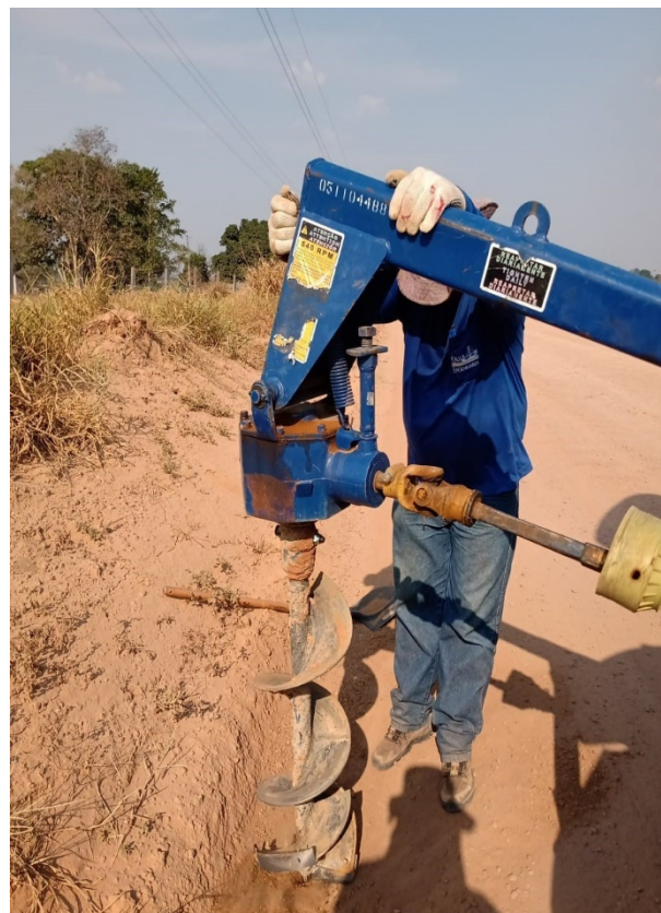
– Sondagem e Coleta de Amostra
