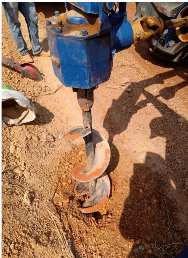
– Sondagem e Coleta de Amostra
