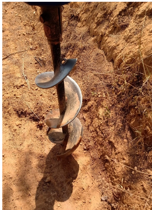
– Sondagem e Coleta de Amostra
