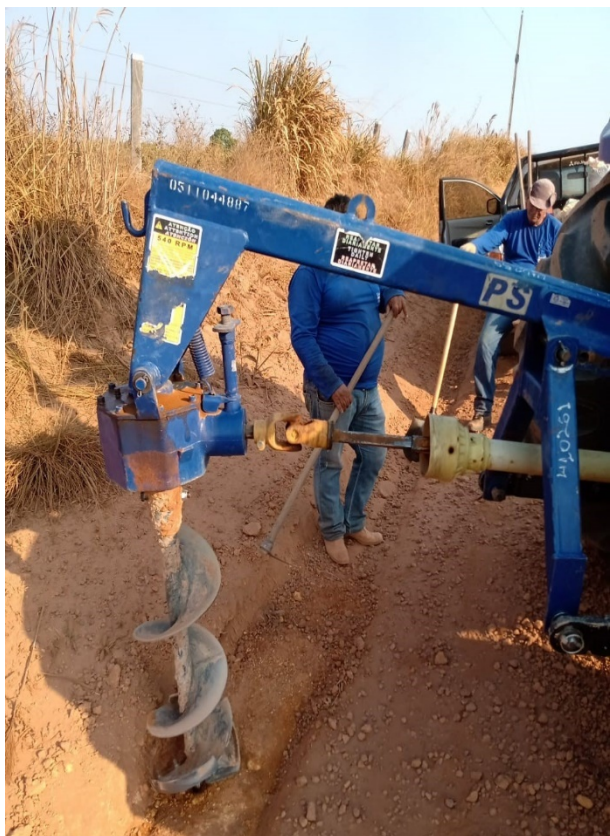
– Sondagem e Coleta de Amostra
