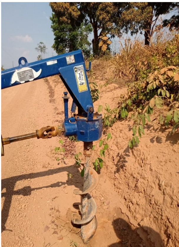
– Sondagem e Coleta de Amostra
