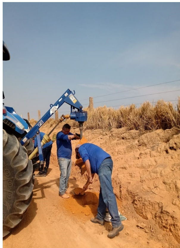
– Sondagem e Coleta de Amostra
