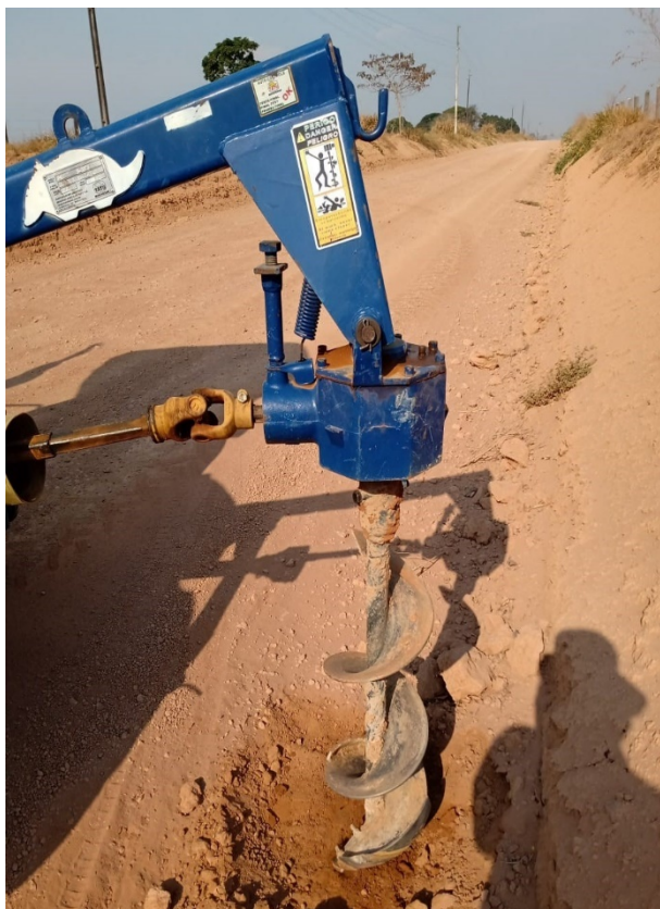
– Sondagem e Coleta de Amostra
