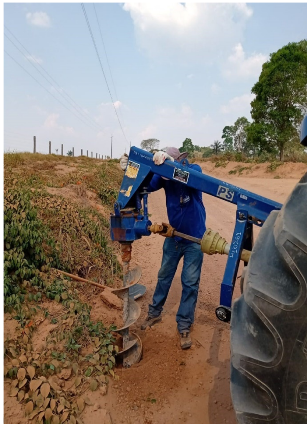
– Sondagem e Coleta de Amostra
