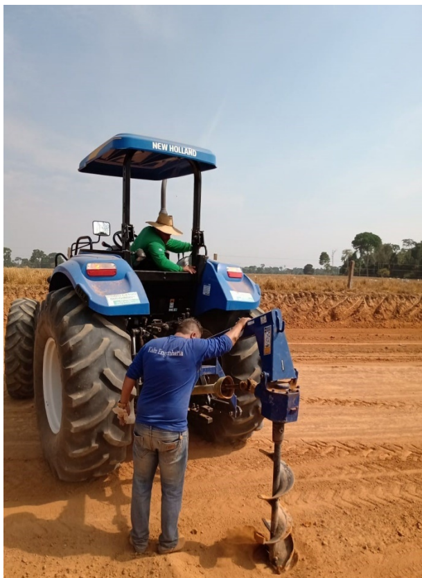
– Sondagem e Coleta de Amostra
