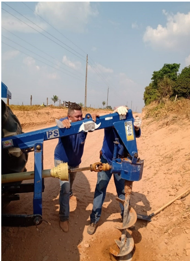
– Sondagem e Coleta de Amostra
